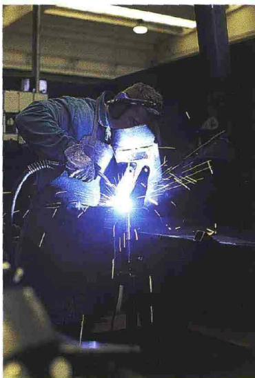
Un atteggiamento responsabile nello svolgimento di determinati compiti prevede l'addebiatamento e l'utilizzo di dispositivi di protezione individuale. Come ad esempio per la saldatura dell'acciaio che produce fumi nocivi.
